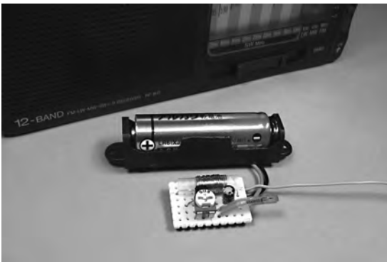
〈写真1〉 たった1石で作れる温度テレメータ(ラジオから「コツ、コツ」とクリック音が聞こえる)
