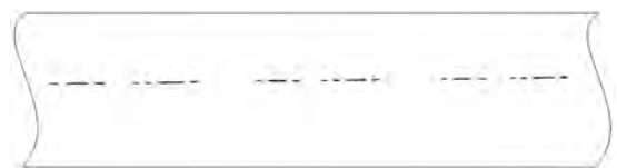
〈図1〉火花放電式送信機からの電波を受信して得られたモールス符号印字出力(RFの繰り返し)
