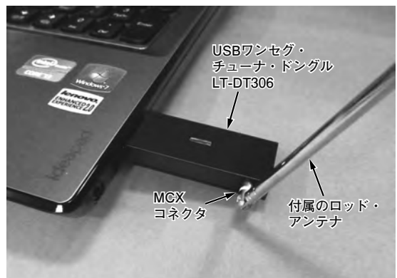
〈写真2〉 市販のUSBワンセグ・チューナでは付属ロッド・アンテナを使って受信する
