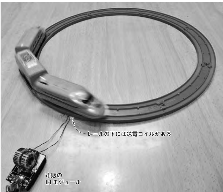
〈写真1〉IHモジュールを使った走行中給電で走行するWPTプラレール
