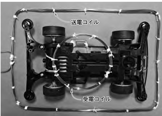
〈写真1〉送電コイルと受電コイル(6 MHz 用の場合、 kQ = 11 , \eta_{\max} = 86\% )
